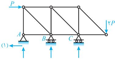
خرپای مقابله را در نظر بگیرید. این خرپا از نظر داخلی یک جسم صلب و معین بوده که با چهار عکس‌العمل تکیه‌گاهی به زمین متصل شده و در مجموع یک درجه نامعین می‌باشد.
