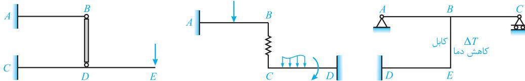
هر یک از این سازه‌ها از اتصال دو قسمت به تنها یک پایدار توسط یک میله، فنر و یا کابل تشکیل شده‌اند و از الگوهای فوق پیروی می‌کنند. ساده‌ترین روند برای حل کلی این گونه از سازه‌ها، جدا سازی سازه از محل اتصال سازه فوقانی یا تحتانی به میله، فنر و یا کابل است. جدول
