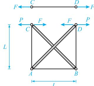
حل: با توجه به مفاهیم فصل سوم کتاب، این خرپا از نظر داخلی یک درجه نامعین است. بنابراین برای تحلیل آن با استفاده از روش نرمی، باید یکی از اعضاء آن را از سازه جدا کرده و با استفاده از یک معادله سازگاری، نیروی عضو آزاد شده را محاسبه کنیم. بدین منظور عضو  $CD$  را از خرپا جدا کرده و عکس العمل نیروی این عضو را روی قسمت باقی مانده خرپا درنظر می‌گیریم. معادله سازگاری در این حالت به صورت زیر درنظر گرفته می‌شود:
