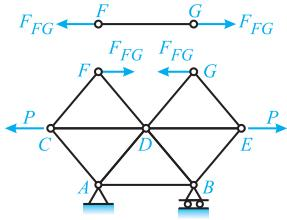
مانند آنچه در فصل ۳ ذکر شده محاسبه کنیم مشخص می‌شود که خرپا از نظر داخلی یک درجه نامعین می‌باشد.
