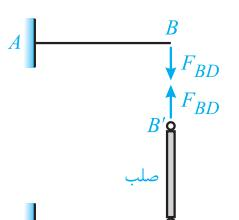
حل: با کمی دقت مشاهده می‌شود که این سازه از اتصال دو جسم به تنها یک پایدار، توسط یک میله صلب تشکیل شده است. بنابراین برای حل، ابتدا سازه را از محل اتصال میله صلب  $BD$  و تیر  $AB$  در  $AB$  باز می‌کنیم و معادله سازگاری را به صورت زیر تعریف می‌کنیم:
