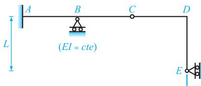
حل: با کمی دقیق مشاهده می‌کنید که قطعه  $AB$  از این سازه یک تیر مفصلی گیردار است که با اضافه شدن قطعه‌هایی به آن، توسعه یافته است. مراحل توسعه شکل، به صورت زیر است:
