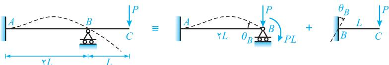
به عبارت ساده‌تر، قطعه کنسولی مانند یک تیر کنسولی است که در نقطه  $B$  دچار نشست دورانی تکیه‌گاه شده است. بنابراین برای محاسبه تغییر مکان قائم نقطه  $C$  کافی است دوران  $B$  را از تیر مفصلی گیردار با استفاده از جدول ارائه شده به دست آورده و در نهایت جابه‌جایی نقطه  $C$  را به دست
