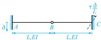
حل: با اندکی دقیق ملاحظه می‌شود که سازه نامعین نشان داده از اتصال دو قطعه کنسولی، توسط یک مفصل خمشی تشکیل شده و یک درجه نامعین است. برای حل ابتدا سازه آزاد شده و معادله سازگاری را برای آن به صورت زیر در نظر می‌گیریم:
